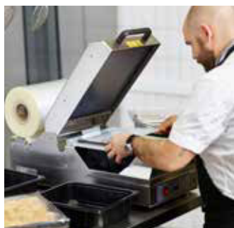
2. Ziehen Sie die Folie mit beiden Händen über die Schale.
