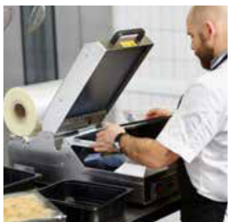
1. Legen Sie die zu versiegelnde Schale in die Kassette ein.
