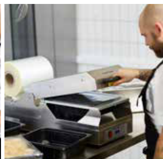
4. Die Maschine öffnet automatisch nach Ende des Siegelvorgangs. (Nicht bei DF10/15)
