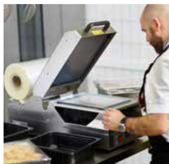
3. Drücken Sie den Maschinendeckel nach unten bis die Maschine zum Siegeln anzieht.
